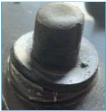
Cọc dương bị nhô hoặc mục khi sử dụng cho máy phát điện
