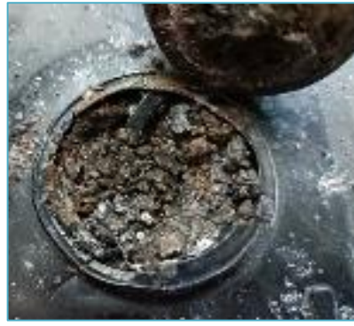
Cọc dương bị nhô hoặc mục khi sử dụng cho máy phát điện
