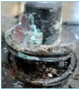
Cọc dương bị nhô hoặc mục khi sử dụng cho máy phát điện
